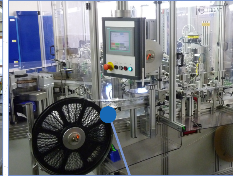
Konfektionierautomation mit Blisterverpackung automated assembly with blister packaging
