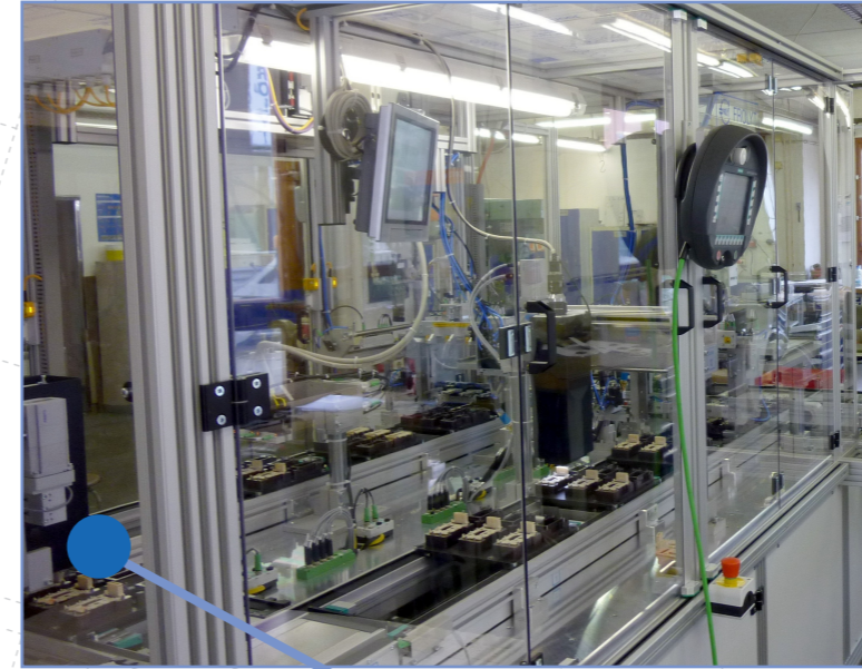
Sondermaschine mit offenem Lineartransfersystem und Mobilepanel machine with open linear transfer system and mobile panel
